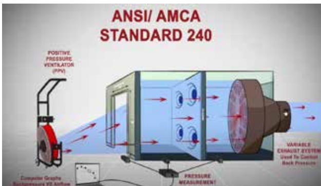
Рис. 5. Робочий момент випробувань переносного засобу димо- та тепловидалення
